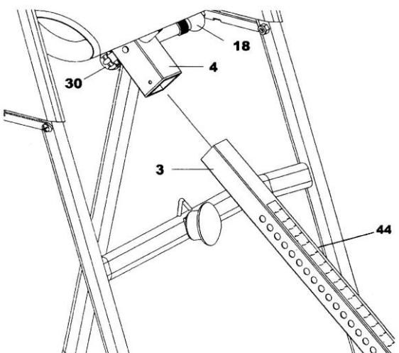
Вытяните фиксатор (30) и передвиньте регулируемую стойку (3) на раме ложемента (4), как показано на рисунке . Вставьте фиксатор обратно, выбрав интересующий вас размер на шкале (44) В целях дополнительной безопасности закрепите фиксатор (30) с обратной стороны. (См. рисунок)
