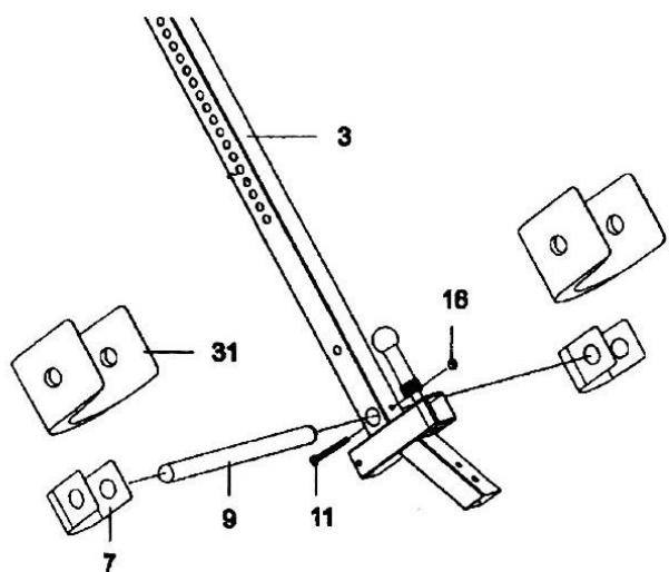
Соедините скобы №7 и №31 со стержнем (9). Вставьте стержень в отверстие на регулируемой стойке (3), как показано на рисунке. Соедините скобы №7 и №31 с другой стороны стержня
