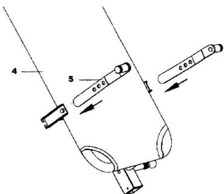
Зафиксируйте регулируемую стойку рамы (5) на кронштейнах, расположенных с каждой стороны рамы (4). Отрегулируйте на необходимом уровне с помощью защелки, вставьте втулку. Рекомендуется пользоваться защелкой до тех пор, пока вы не ознакомились с тренажером полностью.
