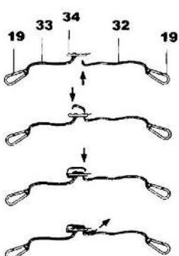
Зафиксируйте нейлоновые тросы (32) на замке петли (34), продев один конец троса в замок, сделайте петлю (33) затем другой конец троса вставьте в замок, как показано на рисунке.
