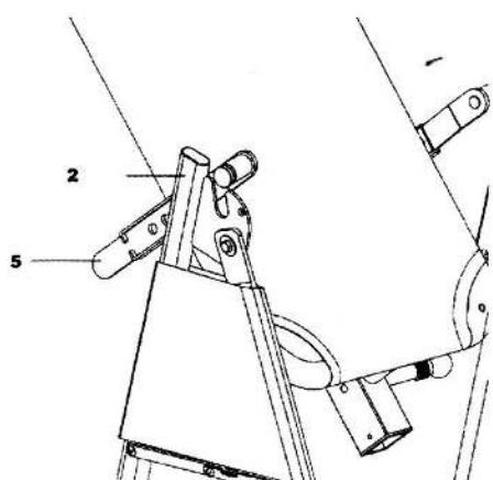
Закрепите раму ложемента (4) на задней U-образной раме(2) вставить концы регулируемой стойке ложемента (5) в отверстиях на пластинах.
