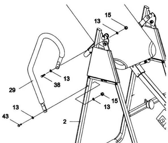
Закрепите руль (29) на задней U-образной раме (2) с помощью болтов (38,43), шайбы (13) и гайки (15), как показано на рисунке.
