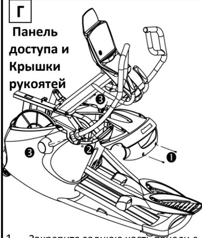
1. Закрепите заднюю часть панели с помощью Б-1 (2шт.)
