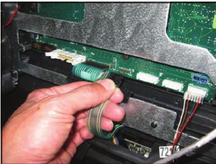
Шаг 11. Подключите кабель клавиатуры центральной консоли в разъем J7 на панели дисплея.
