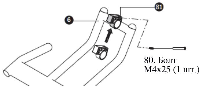
Присоедините фиксатор консоли (81) к рулю (6) с помощью болта (80) и установите консоль (22) в фиксатор консоли, присоединив кабель датчика (23) к консоли.
