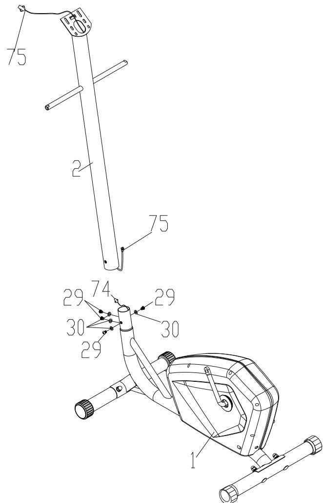
Соедините провода (74) и (75). Закрепите стойку консоли на основной раме (1).
