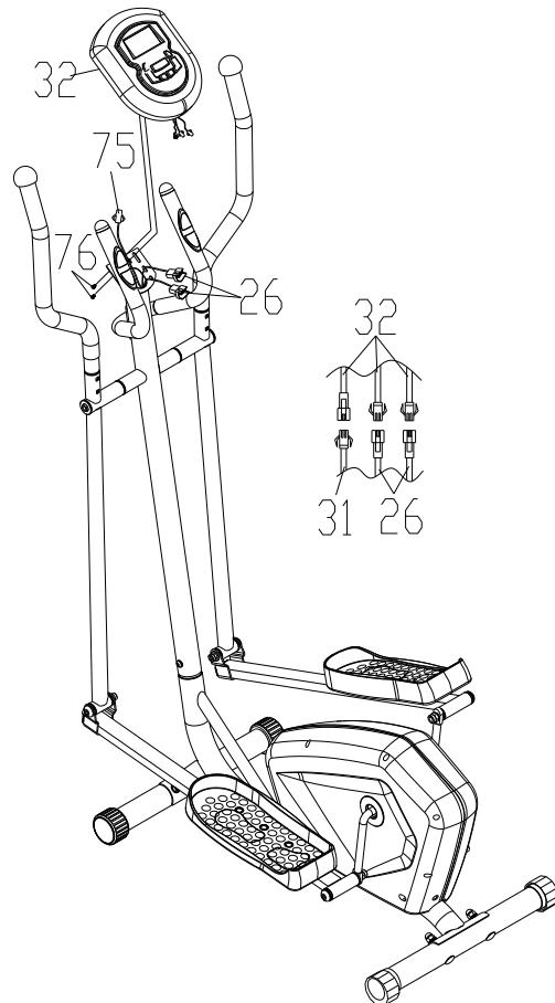
Соедините провода консоли (32) с проводами (32,26). Затем закрепите консоль (32) на стойке (2).
