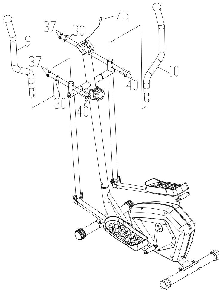
Закрепите нижний (9) и верхний (10) руль на основной раме (1) с помощью болтов (40), шайб (30) и гаек (37).
