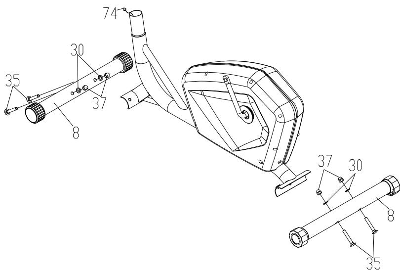
Закрепите переднюю и задние опоры (8) на основной раме с помощью болта (39), шайбы (30) и гайки (37).
