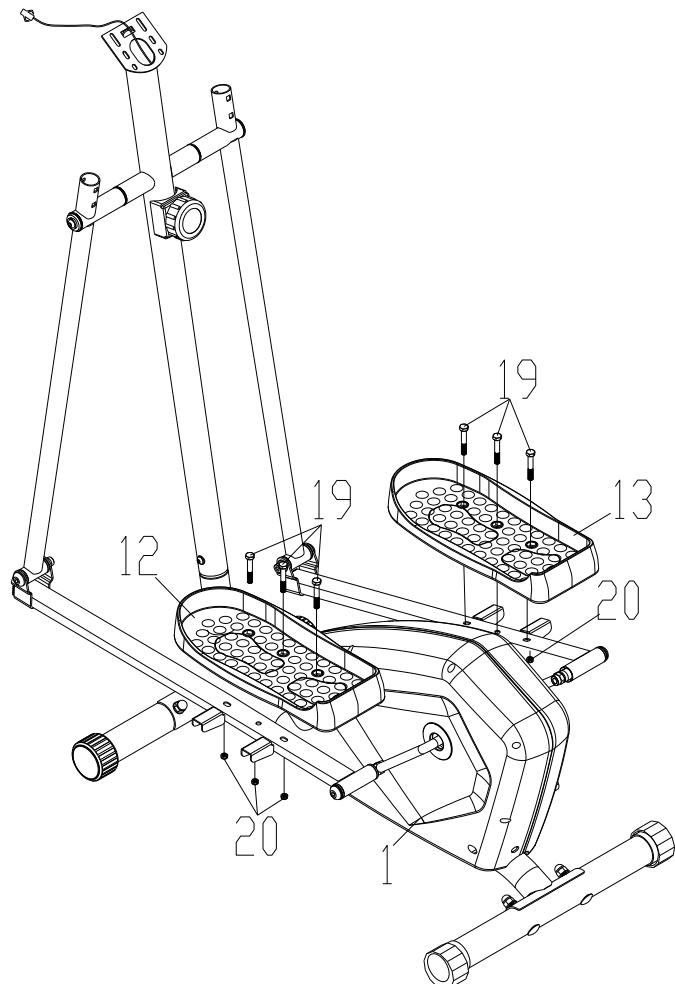
Закрепите левую педаль (12) и правую (13) на основной раме, используя болты (19) и гайки (20).
