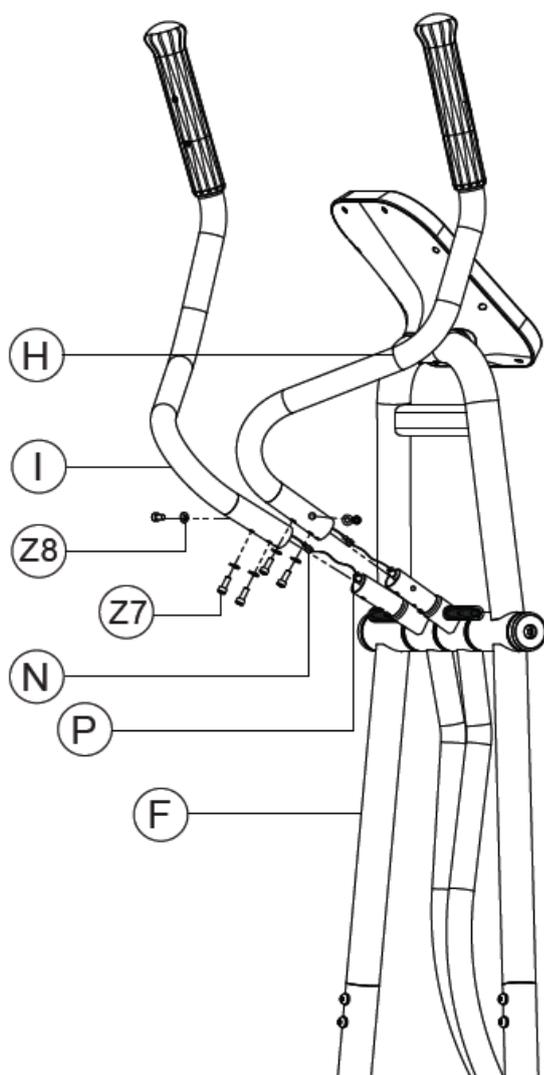
А. Подключите средний кабель пульсомеров (N) к кабелю пульсомеров (P) правого верхнего руля (H).
